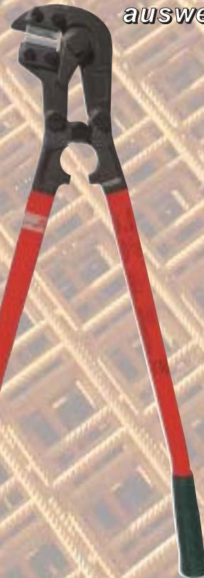
Spezialbolzenschneider zum Schneiden von Baustahlgeweben, geeignet für Spannbetonstähle und Stähle mit einer Zugfestigkeit bis 2100 N/mm<sup>2</sup>. Der maximale Schneiddurchmesser bei 2100 N/mm<sup>2</sup> beträgt 6 mm.
