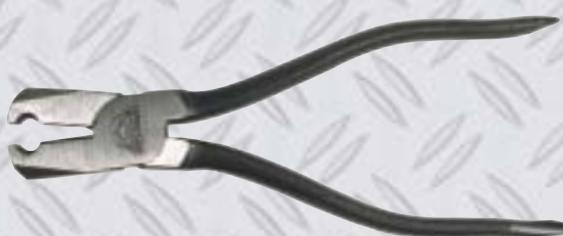
mit Kapselklemmer und Zündschnurabschneider, aus Werkzeugstahl, Kopf poliert, Schenkel brüniert, vom Bundesministerium zur Verwendung für den Bergbau zugelassen
